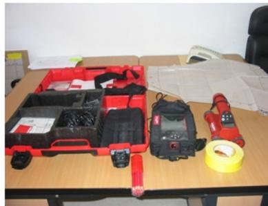
Appareil de détection de ferrailage
